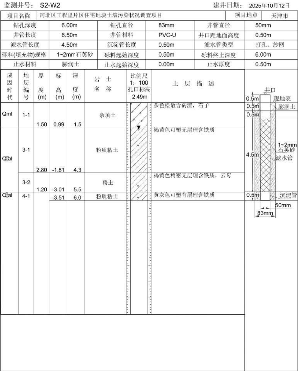
地下水监测井建井结构示意图
