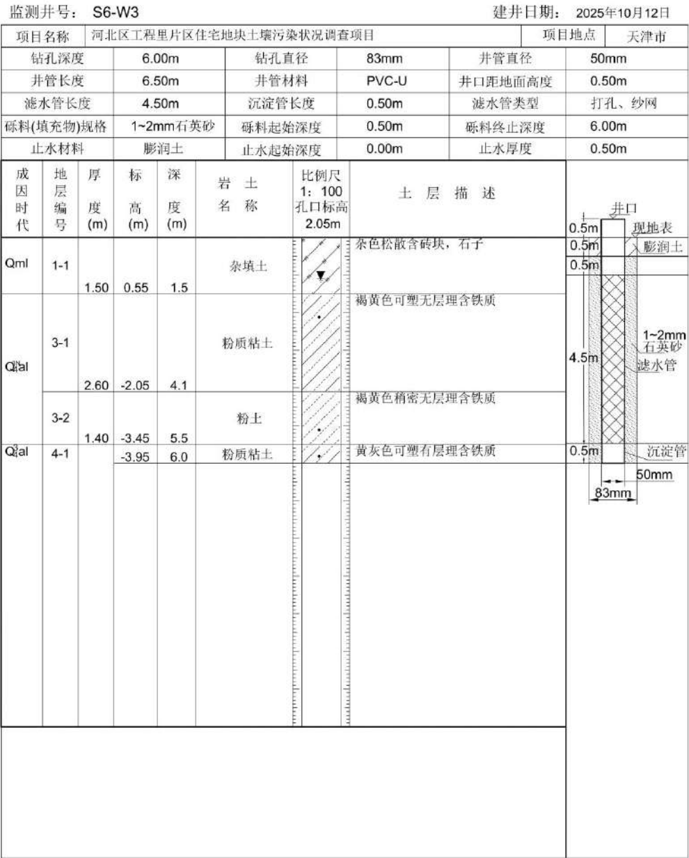
地下水监测井建井结构示意图
