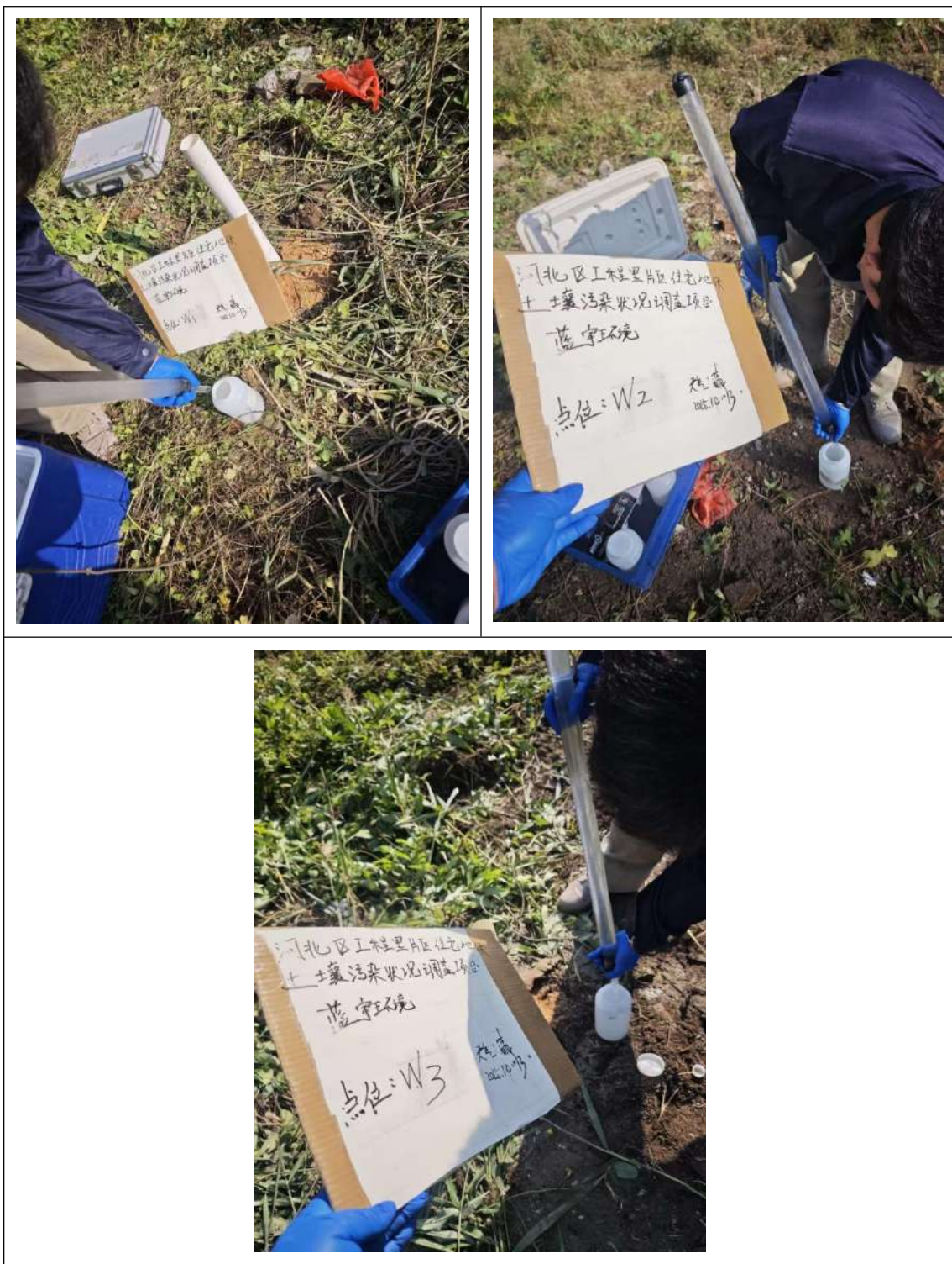
图 6-14 地下水重金属及常规离子样品采样图
