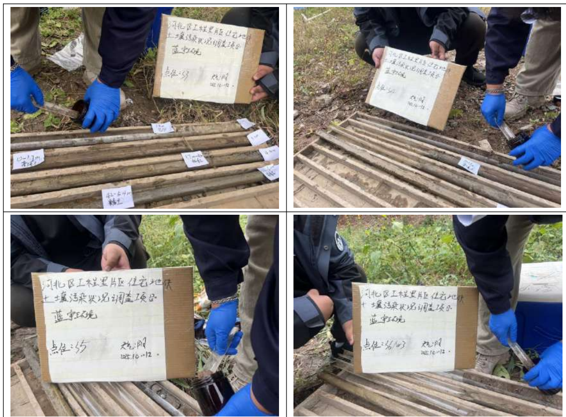
图 6-4 土壤 SVOCs 样品采集图
